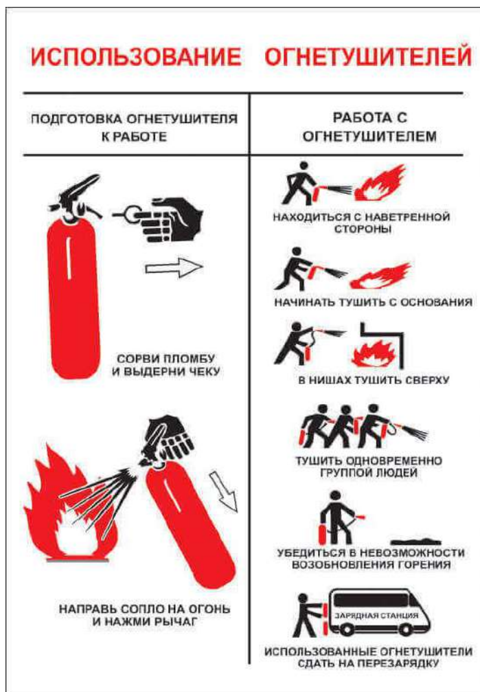
Рисунок 8.1. – Правила использования огнетушителя
